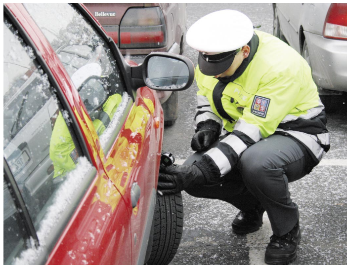
Měření hloubky vzorku pneumatiky.
